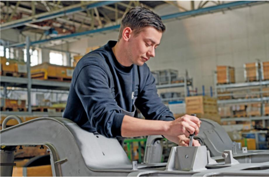
Fahrzeugschlosser Matthias Rotter führt Reparaturen an der tragenden Struktur des Drehgestells und am Drehgestellrahmen durch.
