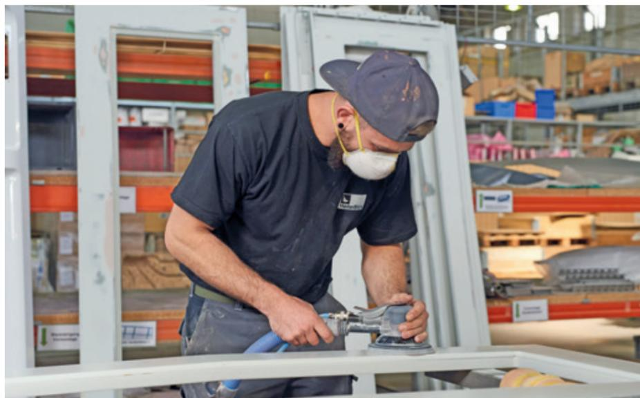
Außenanbauten, wie Türflügel, Dachblenden, Schürzen, Klappen und Scheinwerfermasken werden entsprechend dem Designkonzept des Kunden repariert, aufbereitet und lackiert. Farblich ist dabei alles möglich. Lackierer Martin Leonhardt frischt hier eine Tür wieder auf. In einigen Fällen wird die Form der Karosserie sogar verändert. Einen eckigen Straßenbahnkopf runden die Fachkräfte beispielsweise mit Kunststoff ab, um den Aufprall bei Unfällen zu vermindern.
