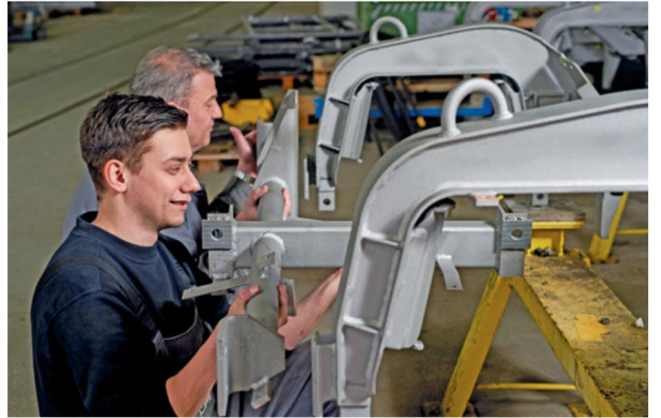
Reno Fricke und Matthias Rotter montieren Anbauteile an den Drehgestellrahmen.
