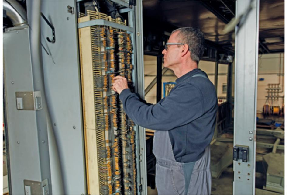
Neben der Sanierung im mechanischen Bereich erneuern Fahrzeugelektriker grundlegend die Elektroausrüstung. Thomas Bose überarbeitet hier den Schaltschrank unmittelbar hinter dem Fahrerarbeitsplatz.
