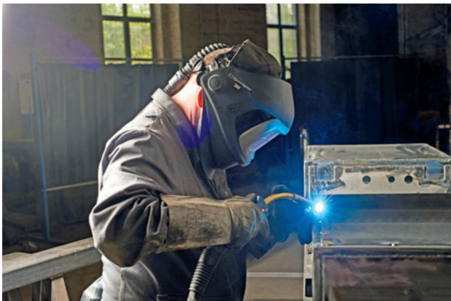
Die modernen Schweißhelme verfügen über selbstverdunkelnde Blenden und versorgen den Schweißer während der Arbeit mit Frischluft.
