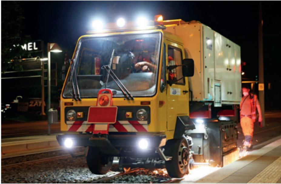
Wer will, dass die Straßen- und Stadtbahnen reibungslos rollen, muss in Schienenpflege investieren. HeiterBlick und die Möser Maschinenbau GmbH aus dem sächsischen Rochlitz machen es vor und fertigen Schienenschleiffahrzeuge der Extraklasse – den Metro Grinder C auf Basis eines eigens dafür entwickelten Zweiwegefahrzeugs.
